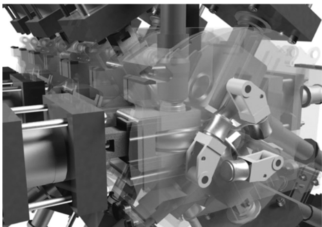
图6 表明电机、减速机和主轴布置特点的5 机架FQM 轧机透视图
