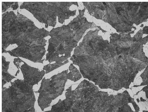
图4 断裂件金相组织 (100×)
