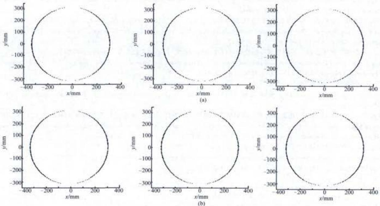
图11 误差补偿后3个截面外径测量结果
