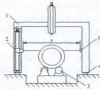
图2 钢管测量及喷标系统侧视图
