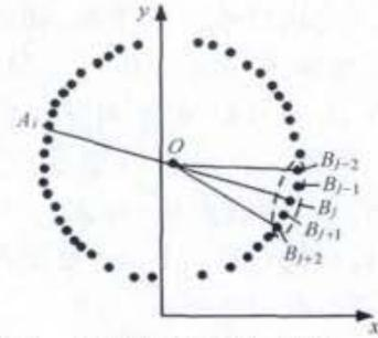
图 4 圆度测量及求解示意图
