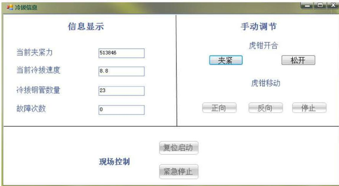
图 5.2 冷拔工艺人机界面
