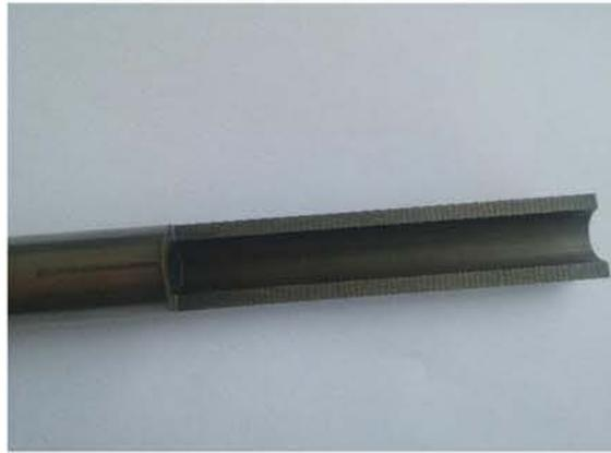
图 2.1 高精度冷拔管
