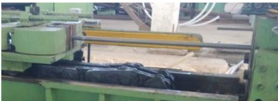
图 2.5 钢管冷拔过程
