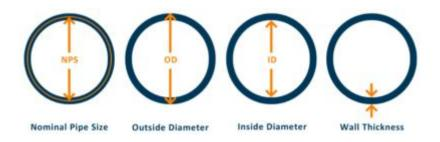
NPS vs. IPS Pipe System NPS 与 IPS 导管系统
