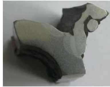
(a) 管子与鳍片角焊缝横截面宏观形貌
